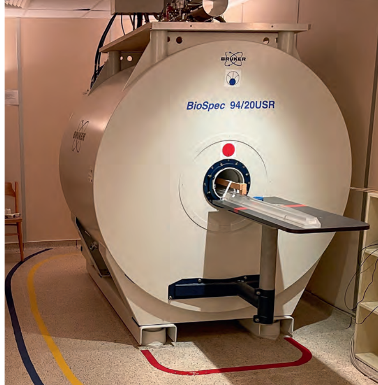
▲ Fot. Tomograf doświadczalny magnetycznego rezonansu z horyzontalnym magnesem nadprzewodzącym 9.4 T w Zakładzie Tomografii Magnetyczno-Rezonansowej
