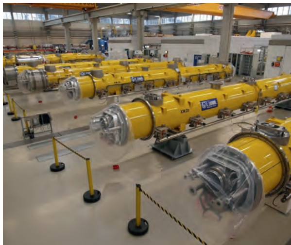
▲ ► Fot. Moduły przyspieszające i wnęki rezonansowe testowane dla E-XFEL przez inżynierów i techników Działu Budowy Aparatury i Infrastruktury Naukowej
