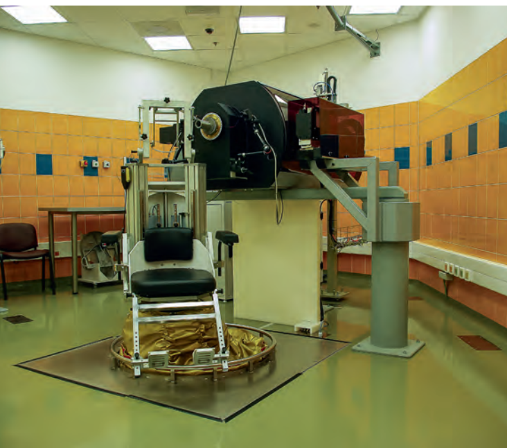
▲ Fot. Widok ogólny stanowiska radioterapii protonowej nowotworów oka przy cyklotronie C-230
